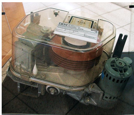
Antiguo disco duro de IBM (modelo 62PC, «Piccolo»), de 64,5 MB, fabricado en 1979.
