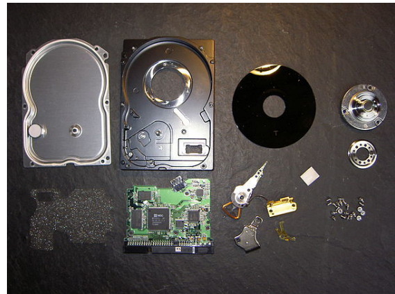
Componentes de una unidad de disco duro. De izquierda a derecha, fila superior: tapa, carcasa, plato, eje; fila inferior: espuma aislante, circuito impreso de control, cabezal de lectura/escritura, actuador e imán, tornillos.
